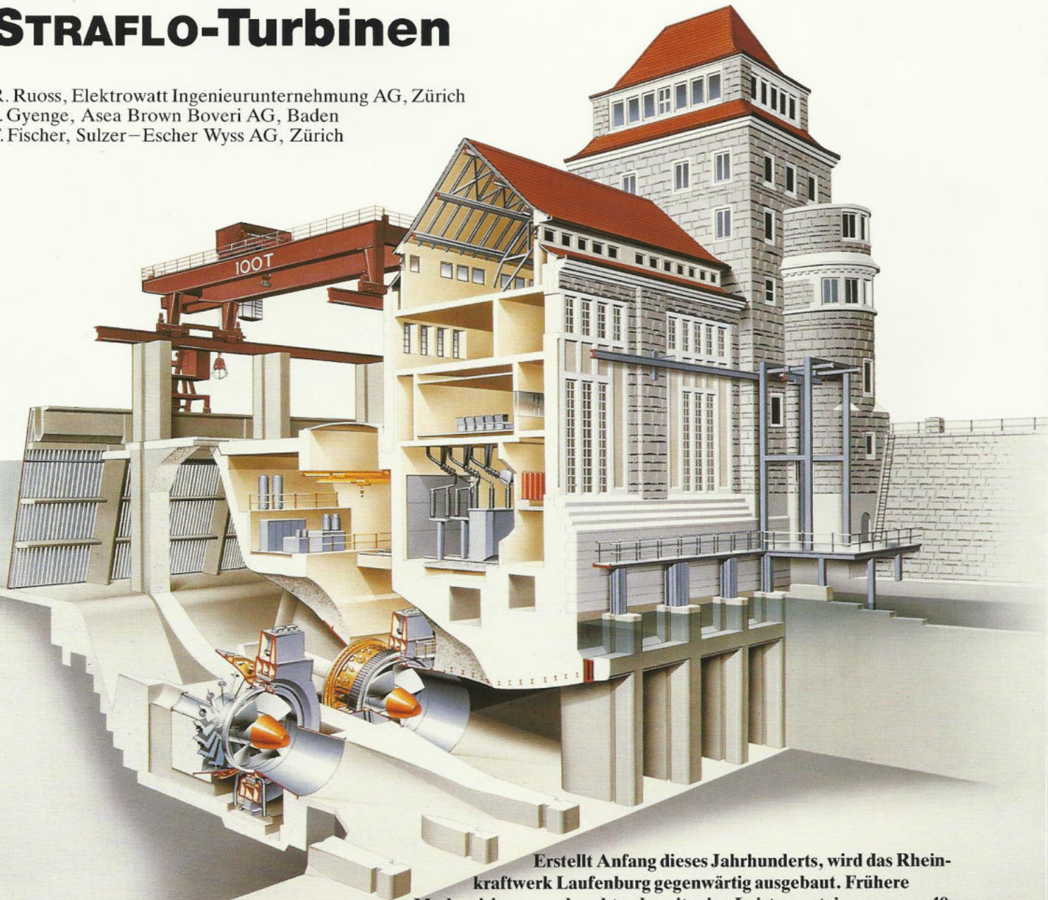
1 Rheinkraftwerk Laufenburg, nach dem Ausbau mit STRAFLO-Turbinen.
