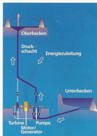
Funktionsprinzip eines Pumpspeicherkraftwerkes mit horizontaler Wellenanordnung:
